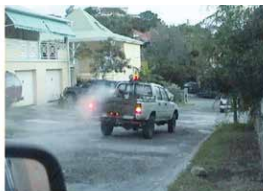
Fig. 22 : pulvérisation à Ultra Bas Volume de deltaméthrine.
