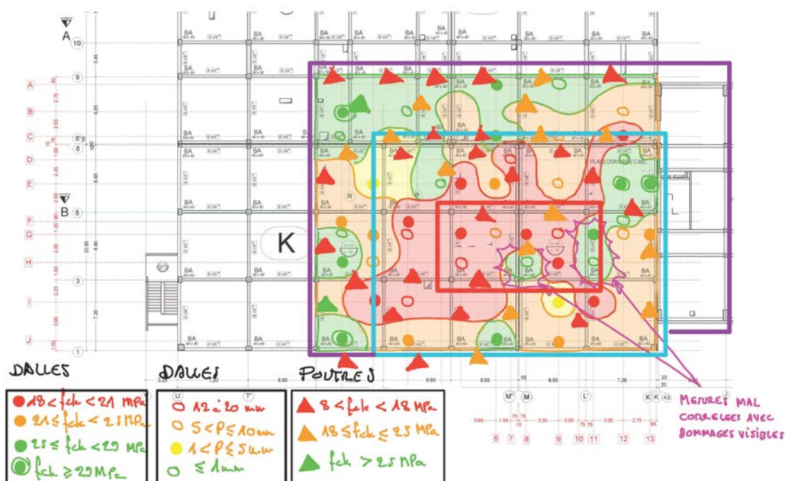
Fig 1 : Superposition des résistances mesurées en poutres avec les résistances et profondeurs d'altération des dalles de la note technique n°09
