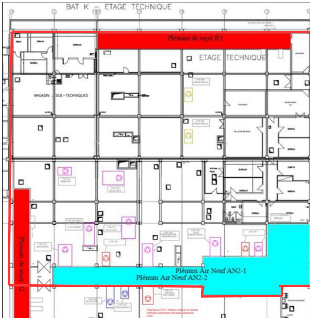
Figure 7 : Zone à confiner (délimitation en rouge) Bât. K étage technique, délimitée par le sas d'accès et les plenums d'AN et de rejet – Extrait schéma de principe climatisation – Gamma Ingénierie
